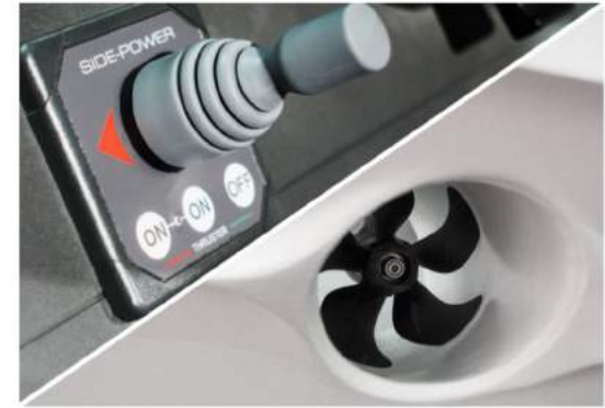
Bowthruster Side-Power SE40
